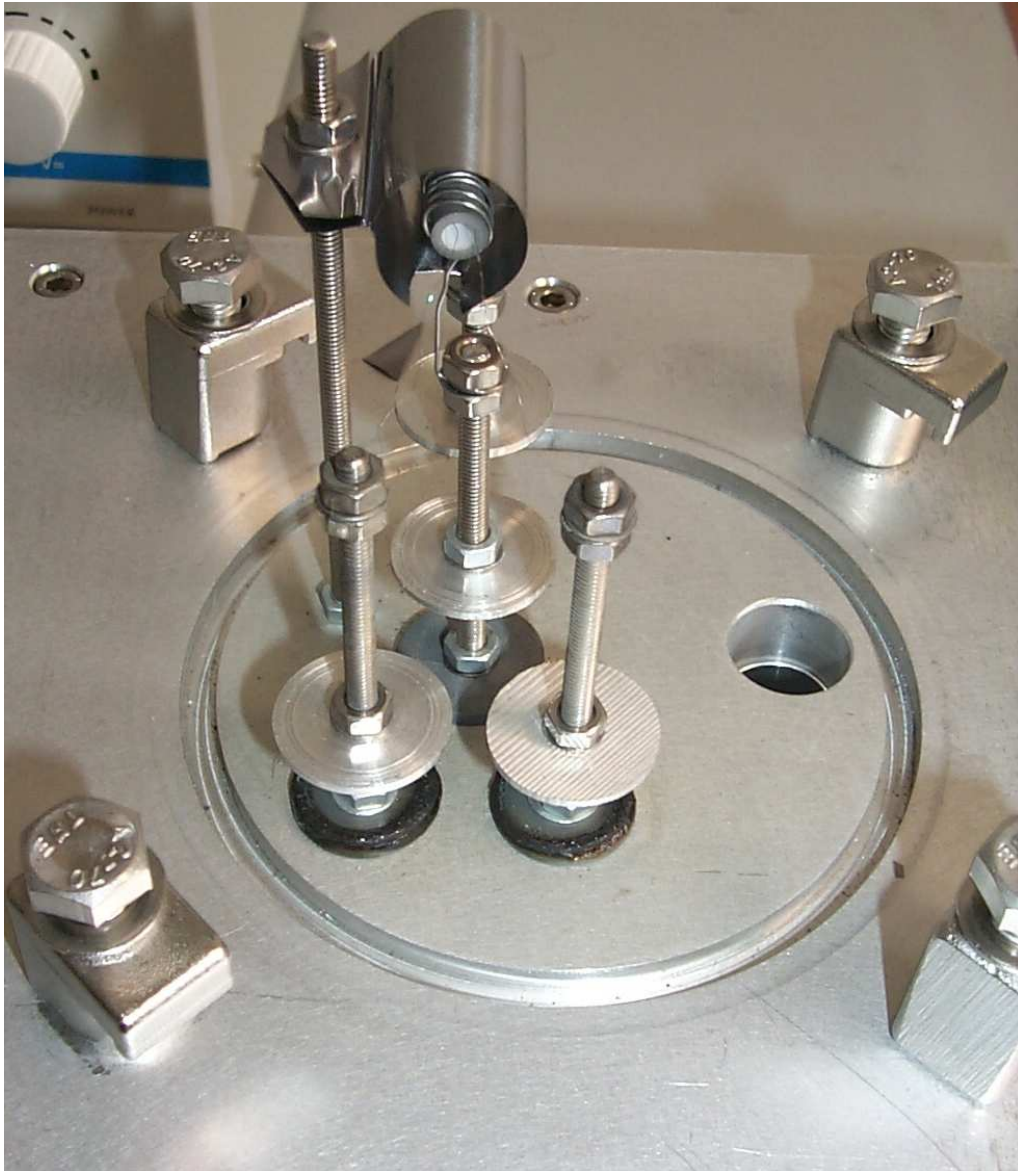
Abbildung A.2: Offener Vakuumofen mit einem Hitzeschild.
