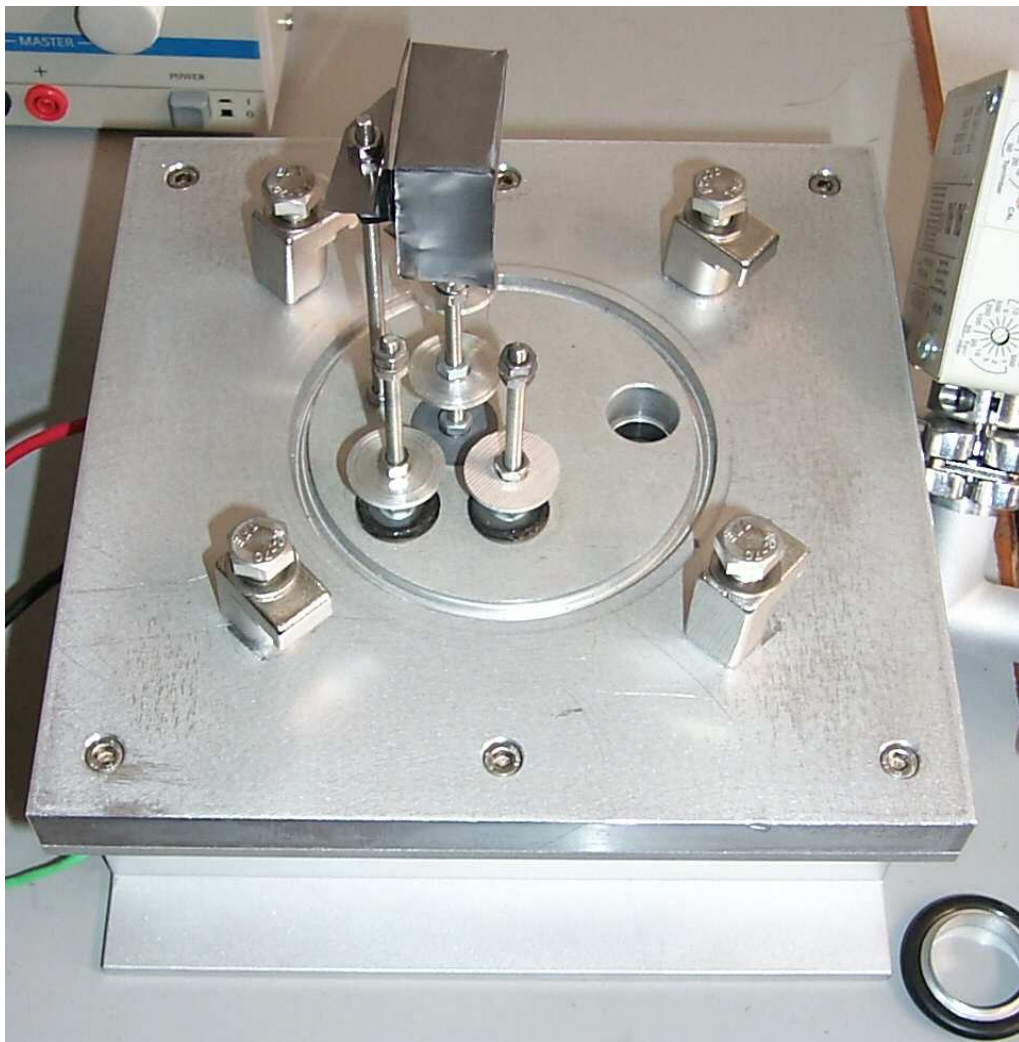
Abbildung A.1: Offener Vakuumofen mit beiden Hitzeschildern. Durch das Loch in der Platte wird die Luft abgepumpt.
