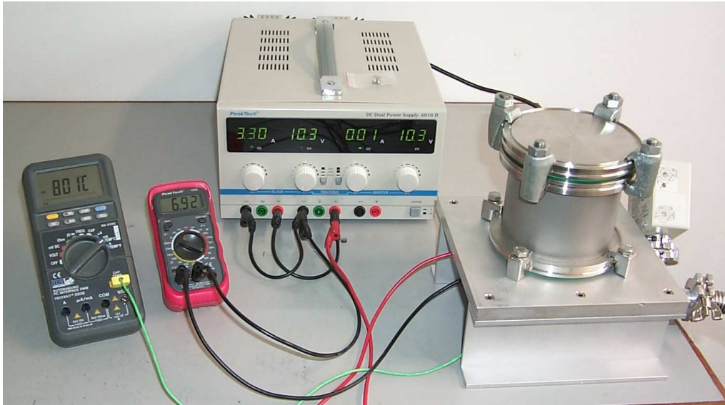
Abbildung A.5: Geschlossener Vakuumofen in Betrieb. Geräte von links nach rechts: Temperaturmessgerät, Ampèremeter, Netzgerät, Vakuumofen, Drucksonde
