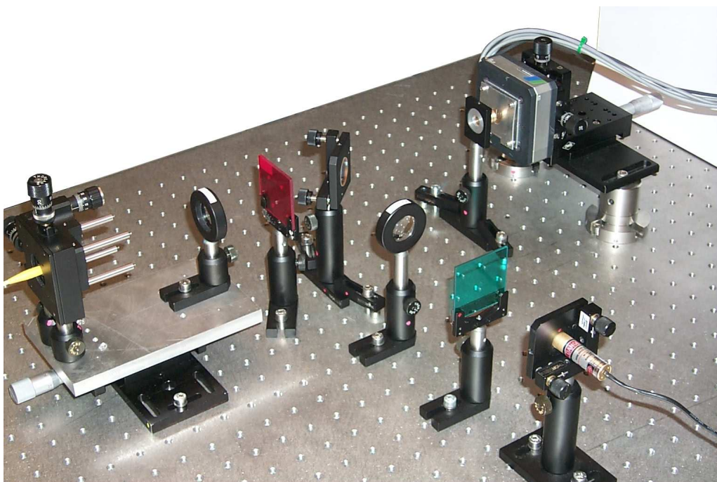
Abbildung B.1: Konfokales Mikroskop mit Sammellinse im Detektionsarm.
