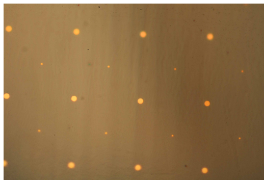
Abbildung D.0-1.: Lichtmikroskopische Teilaufnahme des Gold-Gitters. Die Gitterkonstante der Punkte ist jeweils g = 50 \mu\text{m} . Der Punktdurchmesser beträgt d_{\text{gro\ss}} = 5 \mu\text{m} bzw. d_{\text{klein}} = 2.5 \mu\text{m} .
